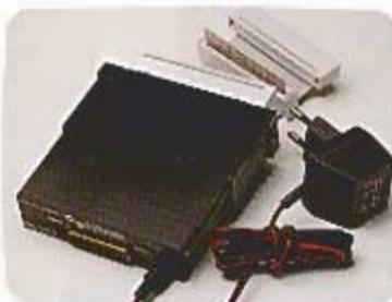
**RS232-Schnittstelle** für den Anschluß peripherer Geräte mit serieller Schnittstelle wie Schreibmaschine, Steuergeräte, Akustikkoppler usw. Komplett mit Kabel und Stromversorgung
