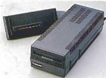
**Diskettenlaufwerk** zur Speicherung
